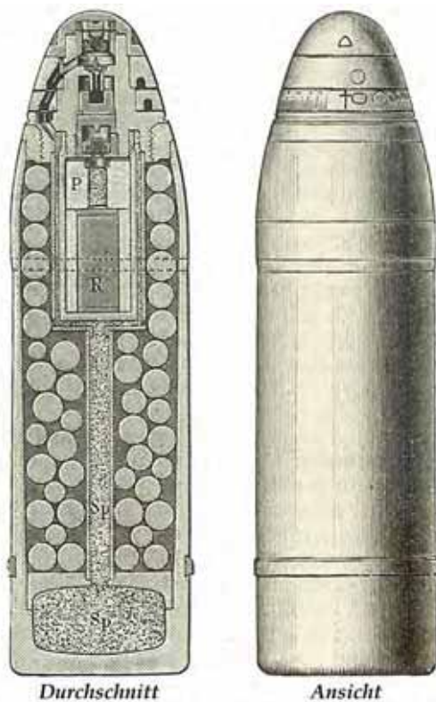
Fig. 3. Brisanzschrapnell, System Ehrhardt-van Essen. P Pikrinladung, R Rauchentwickler, Sp Sprengladung
