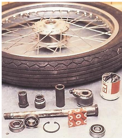
Montageteile einer Radnabe
